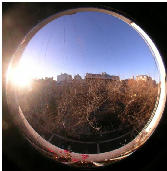
Fig. 18 Fotografía hemisférica del entorno tomada desde la ubicación del sensor. Caso 1. Zona de fachada parcialmente asoleada. Tercer piso.
