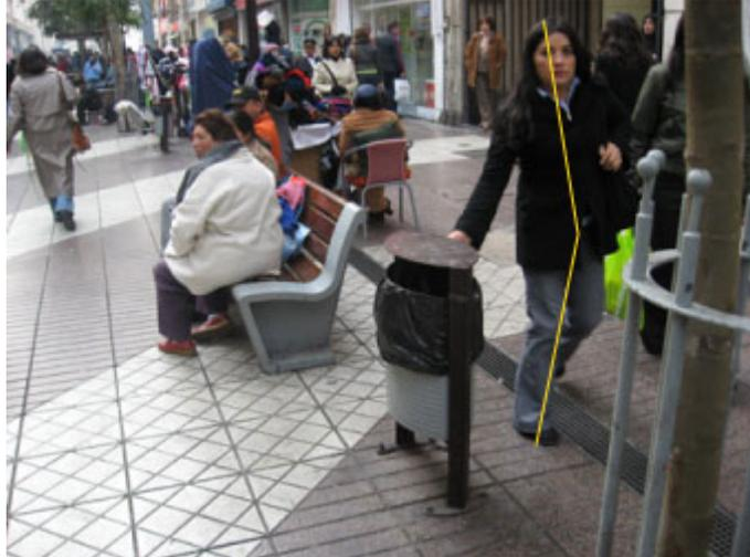
**Fig. 7.** Papelero con altura inadecuada, boca estrecha y confusa para su ubicación.
